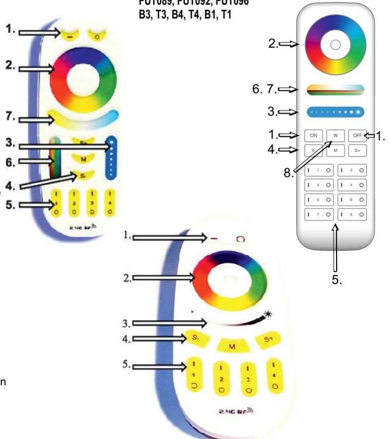
1. Hauptsteuerschalter. Schaltet alle Zonen ein und aus.
